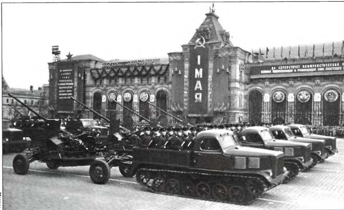
На Красной площади — тягачи АТ-Л (изделие 5) с 57-мм зенитными пушками С-60 на буксире. 1 мая 1956 года
