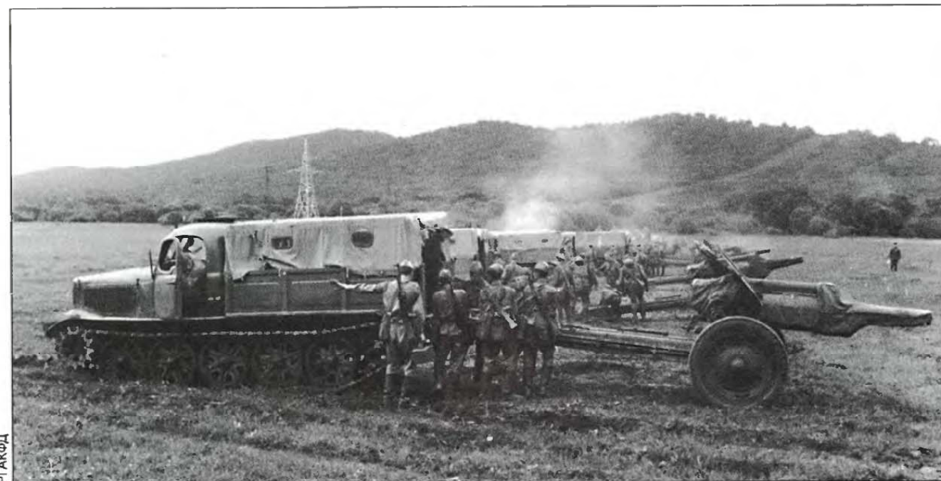
Батарея 122-мм гаубиц М-30 занимает огневую позицию. Тягачи — АТ-Л (изделие 5А). Дальневосточный военный округ, июль 1967 года
